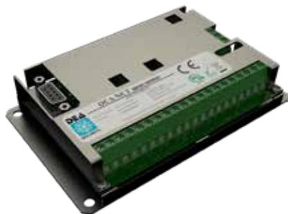
Scheda di interfaccia che permette di veicolare nella rete DEA NET segnalazioni da relè generate da apparati non direttamente compatibili con il sistema DEA NET, come rivelatori e altri dispositivi di terze parti.
