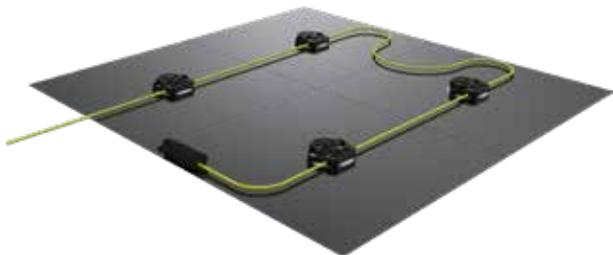
Modulo di rivelazione precablato per la protezione di aree pavimentate con superficie compresa fra 1 e 6 metri quadrati. Il modulo-sensori si compone di 4, 6, 8, 10, 12, 16, 20 o 24 sensori di pressione, di terminazione integrata, di 5 metri di cavo iniziale e di fogli di membrana elastomerica fustellata di 50 x 50 cm.
