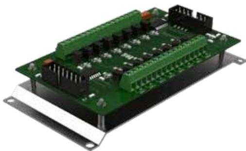
Scheda di espansione a 16 relè per il trasferimento delle segnalazioni di allarme su contatti di scambio C/NC. Tutte le uscite a relè sono programmabili via software da BR-SRP2P-CTRL.
