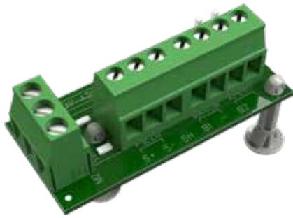
Scheda di interfaccia passiva che permette l'integrazione di sensori della SERIE A03 nel nuovo sistema SERIE A03 PRO. L'interfaccia è dotata di due morsettiere: una per il collegamento di sensori SERIE A03 a 4 o 6 conduttori (più schermo) ed una per il collegamento a un canale libero della scheda di analisi BR-A03P-Z4.
