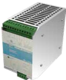
Alimentatore stabilizzato di tipo switching (marca Adelsystem) con tensione in uscita di 24 Vcc e corrente massima erogabile di 3 A. Fornisce due uscite a relè per la segnalazione della fonte di alimentazione utilizzata (rete elettrica o batteria) e dello stato di batteria scarica o danneggiata.
