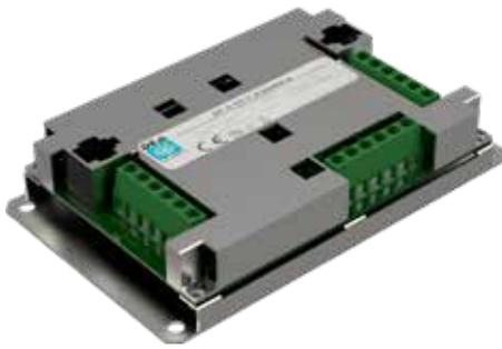
Versione ad alto isolamento della scheda SC-DN-HTRPT per l'uso in siti fortemente disturbati da induzioni elettromagnetiche. Le tre porte di comunicazione presenti sono tra di loro galvanicamente isolate (con tensione di isolamento fino a 2500 VRMS), garantendo un'alta immunità ad eventuali disturbi elettromagnetici che si dovessero propagare lungo la linea di comunicazione.
