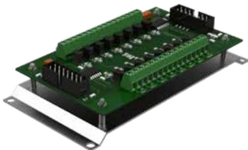
Scheda di espansione a 16 relè per il trasferimento delle segnalazioni di allarme su contatti di scambio C/NC. Tutte le uscite a relè sono programmabili via software da BR-FSP2P-CTRL o BR-FSP2PLT-CTRL.
