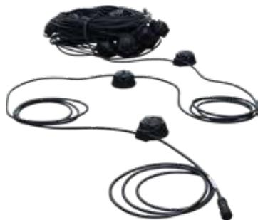
Linea di rivelazione precablata e connettorizzata composta da 25, 10 o 5 sensori SN-SRP2P-300 posizionati a una distanza di 3 metri l'uno dall'altro.
