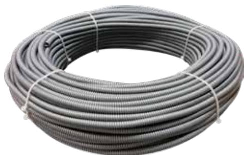
Guaina metallica flessibile per la protezione del cavo di collegamento CB-XS del sensore SN-XS-DR con base a profilo alto. È costituita da acciaio zincato a semplice graffatura con ricopertura in PVC aspirato leggero.
