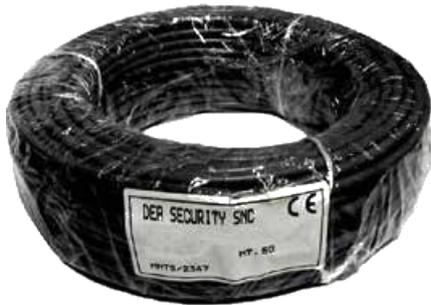
Cavo a 4 conduttori più schermo per il collegamento dell'unità di controllo CU-FSP2P o la scheda di controllo Lite BR-FSP2PLT-CTRL a una linea-sensori non connettorizzata o al cavo connettorizzato di inizio linea CBINL-FSP2P o CBINL-FSP2P-A. Si può impiegare anche per realizzare riparazioni sulla linea o per superare eventuali discontinuità della recinzione (bypass).
