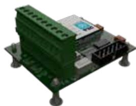
Scheda elettronica che gestisce una seconda linea-sensori per la protezione di ulteriori 50 metri di perimetro. Va inserita nell'Unità di analisi UA-TRC50 e collegata alla scheda elettronica di elaborazione.
