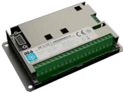
Scheda di interfaccia con logica di funzionamento programmabile che permette di veicolare nella rete DEA NET segnalazioni da relè generate da apparati non direttamente compatibili con il sistema DEA NET, come ad esempio rivelatori di terze parti. È possibile personalizzare le sue funzioni logiche tramite un apposito tool software, fornito in dotazione, che implementa il modello di programmazione in logica ladder.
