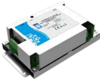
Scheda elettronica di elaborazione che gestisce un modulo-sensori SISMA CA o SISMA CA PF. Questa scheda amplifica, digitalizza e analizza i segnali provenienti dal modulo-sensori, discriminando i segnali tipici di un'intrusione da quelli generati dai disturbi ambientali. La scheda è dotata di un'interfaccia Ethernet e del supporto nativo alle reti IP.
