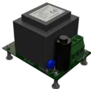
Trasformatore di tensione su scheda impiegato nell'Unità di analisi.
