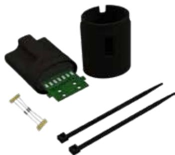
Modulo periferico contenente una scheda elettronica di interfaccia per la gestione di un ingresso a bilanciamento resistivo. Inseribile in qualsiasi punto di una linea-sensori, consente di integrare nel sistema le segnalazioni provenienti da dispositivi di terze parti (ad esempio, contatti magnetici e barriere IR/MW). Il circuito stampato è protetto da un involucro in poliammide che fornisce un'elevata resistenza all'esposizione ai raggi UV e all'abrasione.
