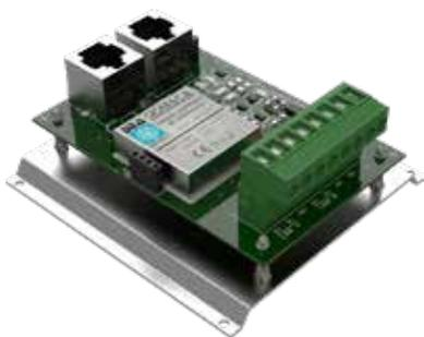
Scheda di interfaccia per un modulo-sensori SISMA CA che amplifica i segnali provenienti dal modulo-sensori e li trasmette alla scheda SC-SMCA-CTRL tramite la rete di comunicazione SMCA NET.
