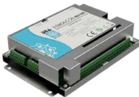
Scheda elettronica di elaborazione che gestisce quattro linee-sensori TORSUS 50. Amplifica, digitalizza e analizza i segnali provenienti dalle linee-sensori, discriminando i segnali tipici di un'intrusione da quelli generati dai disturbi ambientali. La scheda è dotata di un'interfaccia Ethernet e del supporto nativo alle reti IP.
