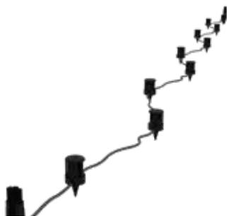
Linea di rivelazione precablata con lunghezza massima di 50 metri. Una linea può essere composta da 12, 34 o 56 sensori SN-SMCP50 per la copertura, rispettivamente, di 10, 30 e 50 metri lineari.
