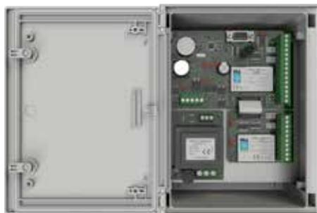
Armadio preassemblato con una scheda elettronica di elaborazione (comprensiva di contatto tamper), una scheda trasformatore e una batteria tampone.
