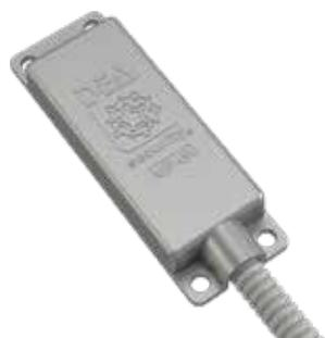
Rivelatore di urti piezoceramico per la protezione da rottura e sfondamento di grate di sicurezza e inferriate in genere. Progettato per operare in ambiente esterno, il sensore è dotato di un involucro metallico e il relativo cavo di collegamento è protetto da una guaina metallica flessibile.
