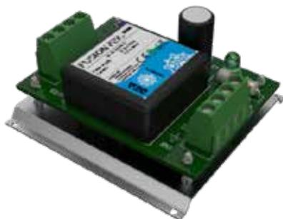
Regolatore di tensione elettronico (booster) da abbinare alla scheda di controllo Lite BR-FSP2PLT-CTRL. La sua funzione è quella di portare la tensione da 12 Vcc in ingresso a 24 Vcc in uscita garantendo l'alimentazione del bus a piena capacità.
