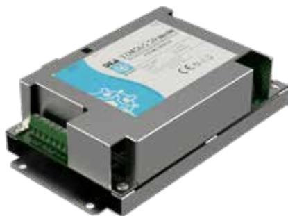
Scheda elettronica di elaborazione che gestisce due linee-sensori TORSUS 50. Amplifica, digitalizza e analizza i segnali provenienti dalle linee-sensori, discriminando i segnali tipici di un'intrusione da quelli generati dai disturbi ambientali. La scheda è dotata di un'interfaccia Ethernet e del supporto nativo alle reti IP.
