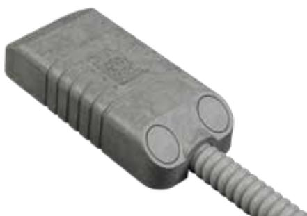
Sensore piezoceramico non alimentato che protegge da taglio, rottura e sfondamento le inferriate e le grate metalliche in genere. Progettato per operare in ambiente esterno, il sensore possiede un involucro stagno in poliammide rinforzato e un cavo di collegamento protetto da una guaina metallica flessibile. SC-XS-GR va collegato alla scheda di analisi BR-XS-GR, la quale elabora i segnali provenienti dal sensore e trasmette le eventuali segnalazioni di allarme alla scheda di controllo.
