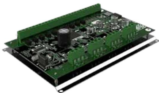
Scheda elettronica digitale multizona per la gestione di tutti i modelli di sensore SERIE A03 PRO. L'unità elabora i segnali provenienti dai rivelatori e genera gli eventuali stati di allarme. L'app di service visualizza gli allarmi differenziandoli per tipo di attacco: scasso (urti di debole intensità), sfondamento (urti di forte intensità), perforazione (vibrazioni continue).
