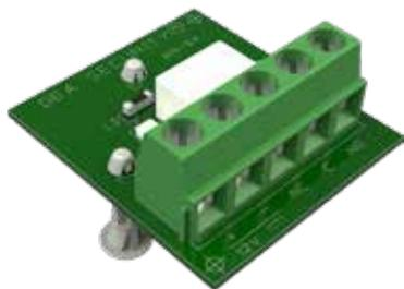
Scheda di espansione a 1 relè per conversione uscita OC in contatto di scambio C/NC/NO.
