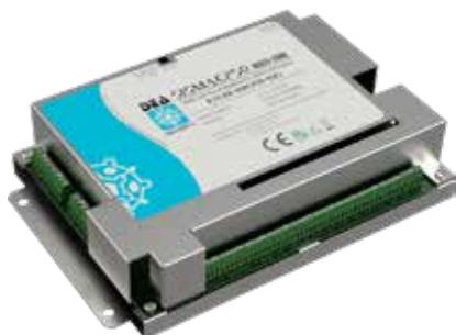
Scheda elettronica di elaborazione che gestisce due linee sensori SISMA CP 50. Amplifica, digitalizza e analizza i segnali provenienti dai sensori, discriminando i segnali tipici di un'intrusione da quelli generati dai disturbi ambientali. La scheda è dotata di un'interfaccia Ethernet e del supporto nativo alle reti IP.
