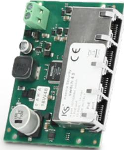
switch 4.0 è uno switch di rete 10/100Mbit pensato per il collegamento delle centrali lares 4.0 con i moduli IP (ergo-T, ergo-T pro, gemino IoT, porta etc) di Ksenia Security. Dispone di 4 porte di rete di cui una PoE (Power over Ethernet) che può essere utilizzata per collegare direttamente un modulo IP. Il dispositivo si alimenta direttamente dall'alimentazione della centrale e garantisce quindi un back up di alimentazione in PoE ai moduli IP.
