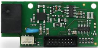
Mediante il modulo PSTN è possibile ampliare le capacità di comunicazione della centrale lares 4.0. Esso consente infatti l'invio delle segnalazioni vocali e contact ID al verificarsi di uno qualunque degli eventi programmati in centrale. È un modulo di rapida installazione, si collega ad innesto sulla scheda madre della centrale, e si collega alla linea telefonica mediante un connettore standard RJ-11.
