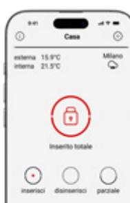
Nell'**homepage** è subito visibile lo stato del sistema antintrusione (inserito / disinserito / parzialmente inserito) ed è sufficiente cliccarci sopra per conoscere lo stato puntuale di ogni singola partizione o inserirle/disinserirle singolarmente.
