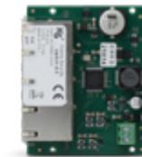
*switch 4.0* è uno switch di rete progettato e realizzato per il collegamento delle centrali *lares 4.0* con i moduli IP di Ksenia Security.
