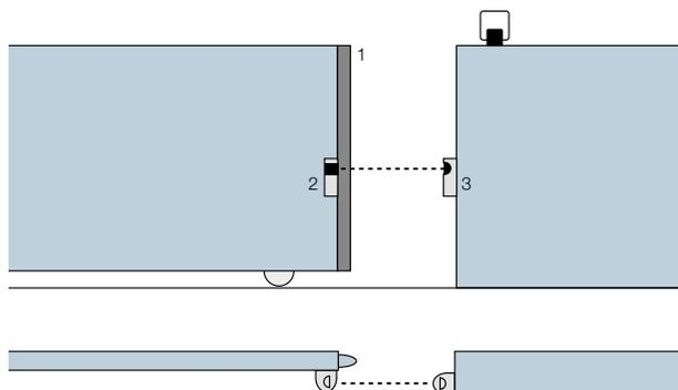
**Dispositivi ottici, con trasmettitore senza fili per fissaggio su anta mobile, orientabili di 210° lungo l'asse orizzontale e di 30° lungo l'asse verticale, per un impianto perfettamente a norma.**
