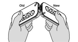
**Scambio del codice di abilitazione** fra un trasmettitore già memorizzato ed uno nuovo, da memorizzare.
