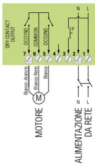
Collegamenti delle uscite per motori meccanici a 3 fili
