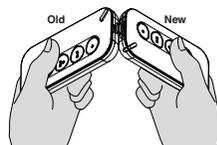
Scambio del codice di abilitazione fra un trasmettitore già memorizzato ed uno nuovo, da memorizzare.
