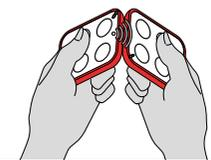
Scambio del codice di abilitazione fra un trasmettitore già memorizzato ed uno nuovo, da memorizzare.
