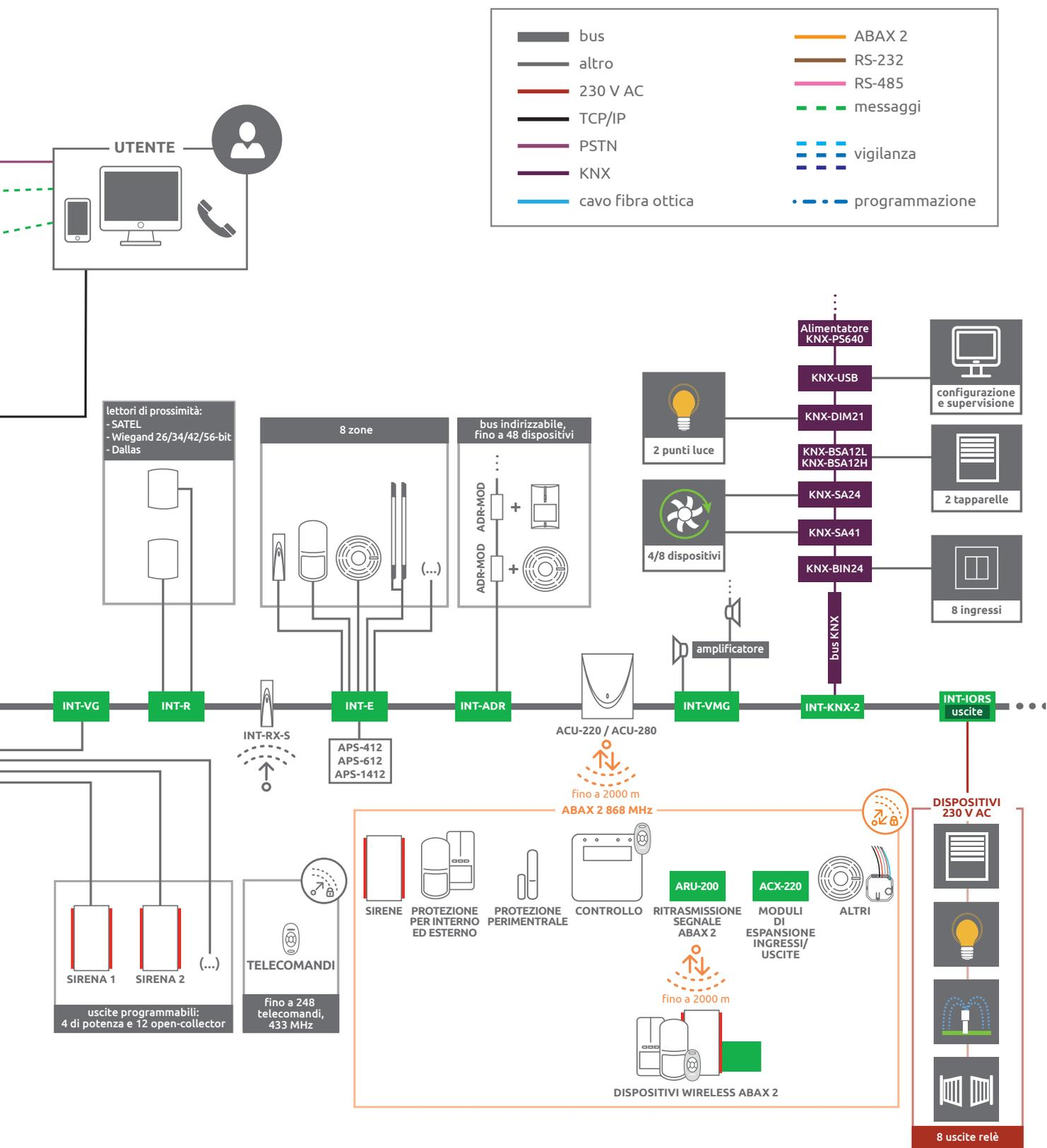
Struttura del sistema di allarme intelligente **INTEGRA Plus**.
