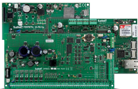
CENTRALI DI ALLARME
