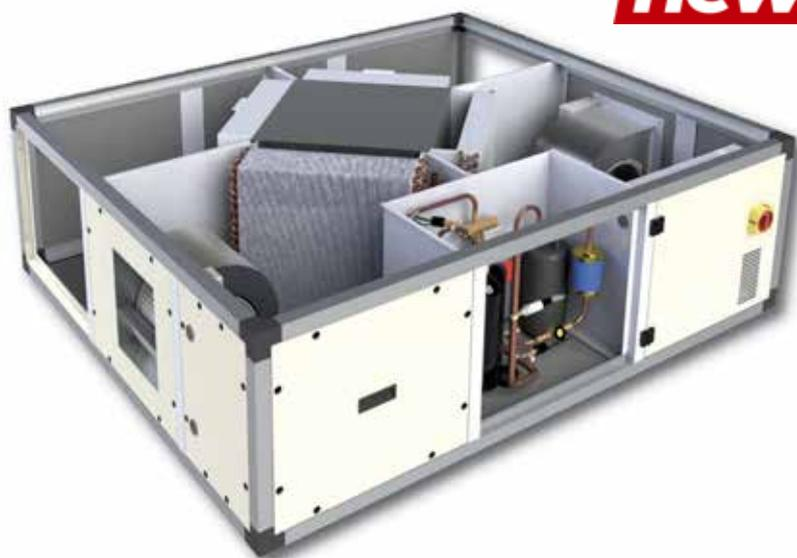
LE UNITÀ DI RINNOVO DELL'ARIA **AIR DYN SYSTEM** SONO CARATTERIZZATE DALL'ADOZIONE DI UN DOPPIO SISTEMA DI RECUPERO DELL'ENERGIA, ALTRIMENTI PERSA NELLA FASE DI ESPULSIONE DELL'ARIA VIZIATA: IL PRIMO, DI TIPO STATICO, MEDIANTE UN RECUPERATORE A FLUSSI INCROCIATI CON PIASTRE IN ALLUMINIO, IL SECONDO (IN CASCATA AL PRECEDENTE), DI TIPO ATTIVO, REALIZZATO MEDIANTE CIRCUITO FRIGORIFERO REVERSIBILE.
