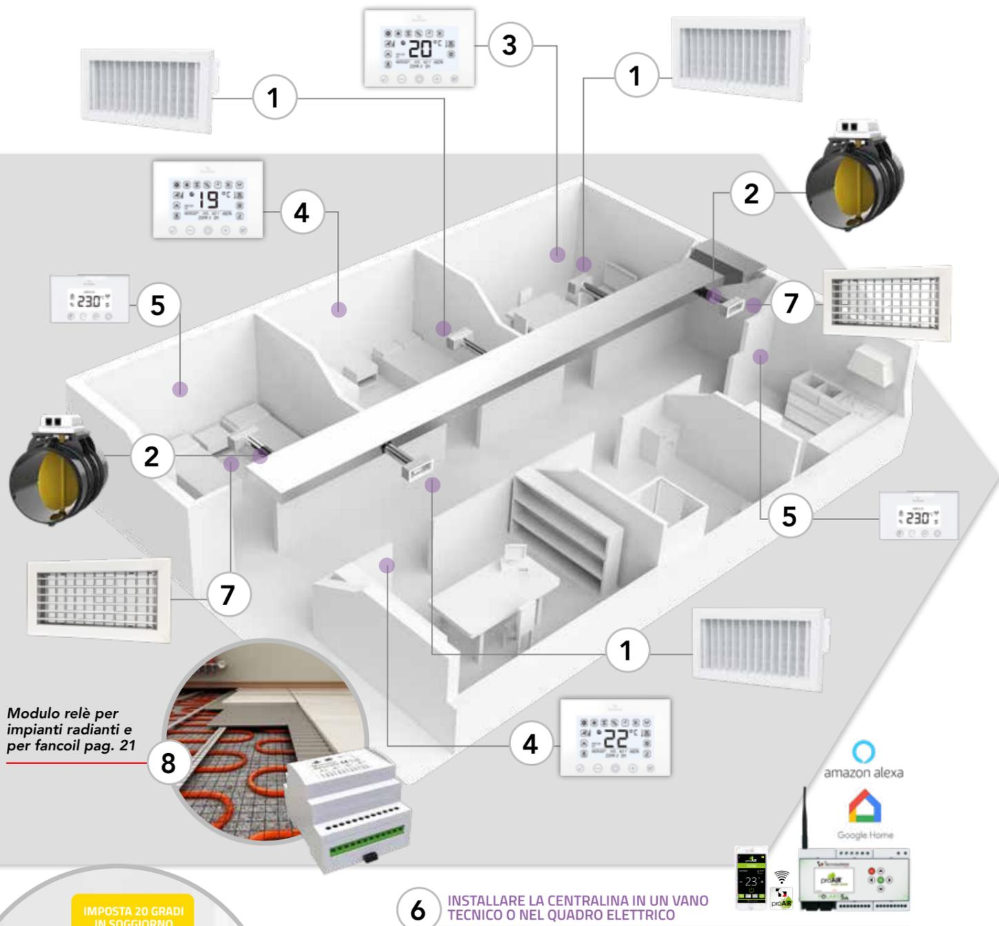
Modulo relè per impianti radianti e per fancoil pag. 21
