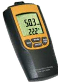
IL TERMOIGROMETRO È UNO STRUMENTO DI MISURAZIONE USATO PER RILEVARE LA PERCENTUALE DI UMIDITÀ E LA TEMPERATURA NEGLI UFFICI, NEI LOCALI E NELLE SERRE ECC.
