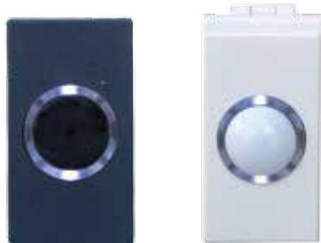
JOLLY IN è il sensore da incasso ad alta affidabilità, derivato da JOLLY MICRO, evoluto con piroelettrico quadruplo e nuova lente che consente rilevamenti fino a oltre 2 mt di altezza di installazione. Una ghiera luminosa circonda la lente con luce bianca che segnala il rilevamento e una tenue luce impostabile come segna passo.
